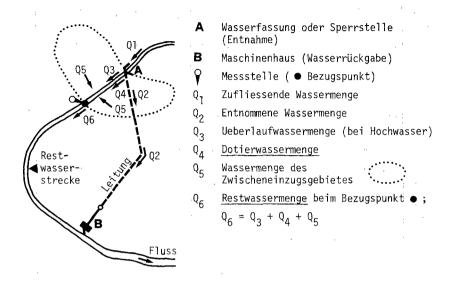
Die Abbildung zeigt den Unterschied zwischen Restwasser und Dotierwasser. Als Dotierwasser wird diejenige Wassermenge bezeichnet, die bei der Wasserfassung ständig ungenutzt weiterfliesst. Restwasser hingegen ist die an beliebiger Stelle eines Flusses unterhalb der Wasserfassung gemessene Abflussmenge. Auch das Wasser von Zuflüssen zwischen Fassung und Rückgabe gehört dazu.
