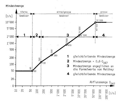
Die im Gesetzesentwurf vorgesehene Mindestrestwassermenge. In den weitaus am häufigsten auftretenden Fällen, d.h. zwischen  $Q_{347}=160~1/s$  und  $Q_{347}=60\,^{\circ}000~1/s$ , entspricht die Kurve weitgehend der Formel Matthey.
