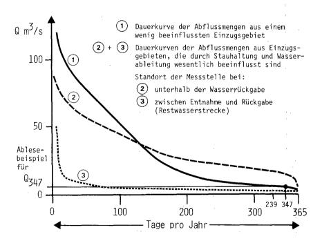
Die Abbildung zeigt die Unterschiede zwischen den Dauerkurven der Abflussmengen bei einem Abflussverhalten, das durch Stauhaltung, Entnahme oder Zuleitung von Wasser beeinflusst bzw. nicht beeinflusst wird. Zur Berechnung der Restwassermenge dient die Abflussmenge  $\mathbb{Q}_{347}$  bei wenig beeinflusstem Abflussverhalten des Gewässers. Liegen keine direkten Messungen vor, so kann sie mit Hilfe wissenschaftlich ermittelter Abflussmengen pro Flächeneinheit berechnet werden.
