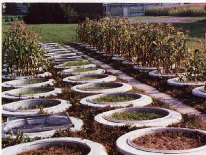
Les lysimètres de Liebefeld permettent de mesurer le lessivage de substances nutritives, comme les nitrates, sous différentes cultures.
