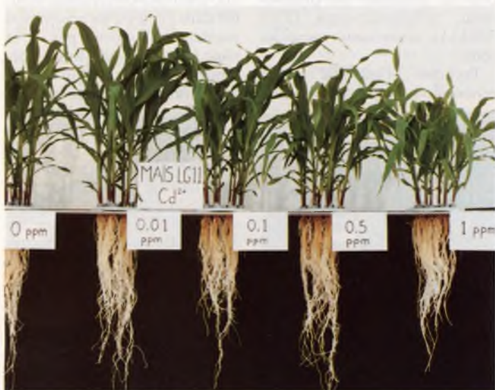
L'effet du cadmium sur les plantes et la croissance des racines est testé sur le maïs.
