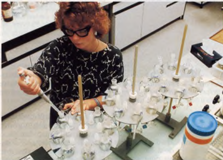
Rationaliser, c'est simplifier les méthodes. Cette opération, extraction et pipettage manuel (à gauche), doit céder le pas à des méthodes plus rapides, ici spectromètre d'absorption atomique en four en graphite pour les oligo-éléments et les métaux lourds (à droite).
