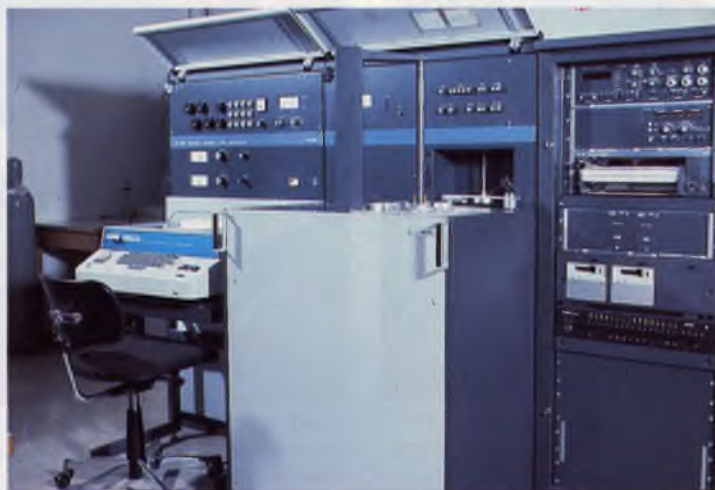
Pour les grandes séries d'analyses le spectromètre automatique de fluorescence de rayons X; il peut travailler jour et nuit quasiment sans surveillance.
