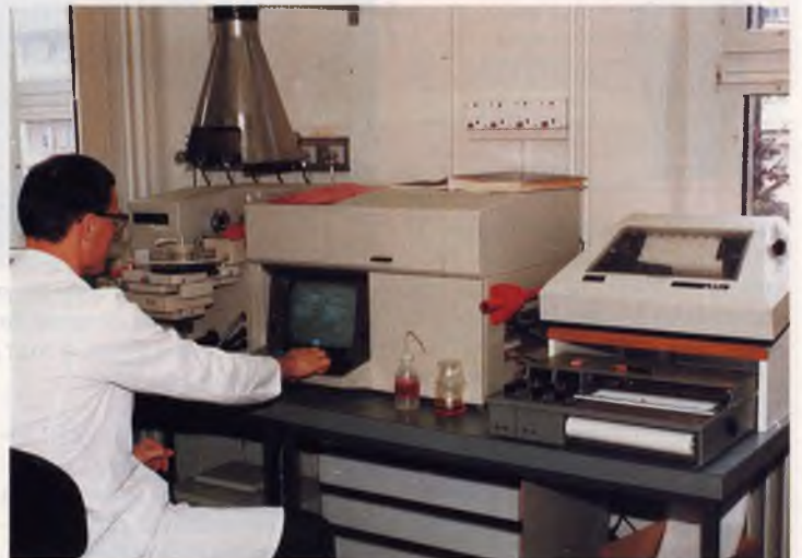
Rationaliser, c'est simplifier les méthodes. Cette opération, extraction et pipettage manuel (à gauche), doit céder le pas à des méthodes plus rapides, ici spectromètre d'absorption atomique en four en graphite pour les oligo-éléments et les métaux lourds (à droite).
