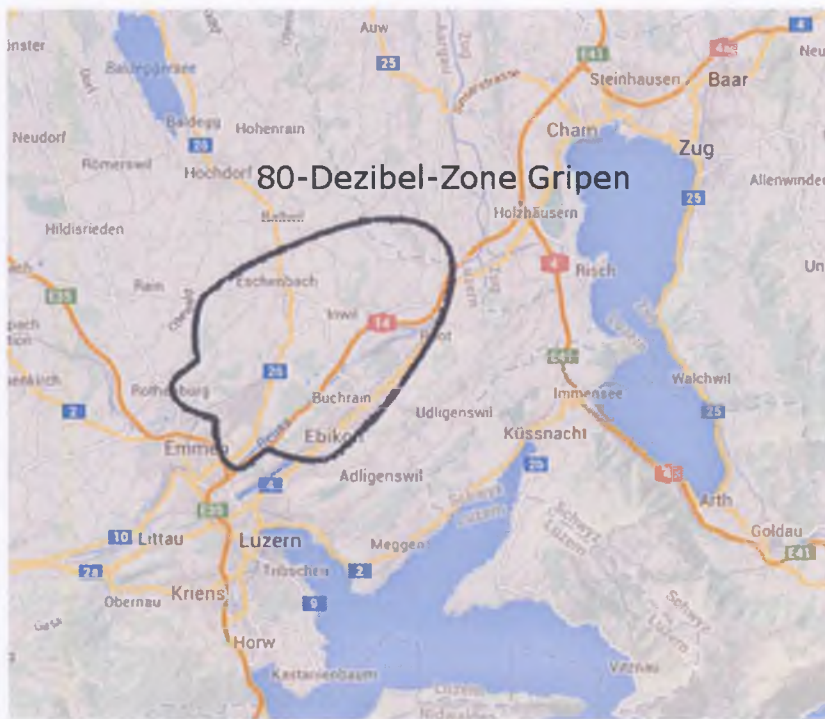
Dans la zone en noir autour de l'aérodrome d'Emmen, le niveau de bruit estimé au décollage du Gripen dépasse les 80 décibels. (Graphique : Coalition contre l'achat des nouveaux avions de combat; forme et taille du cône des 80 dB. Armasuisse)
