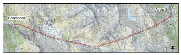
Die zweite Gotthard-Strassenröhre (rot) wird parallel östlich zur bestehenden Röhre geführt.
